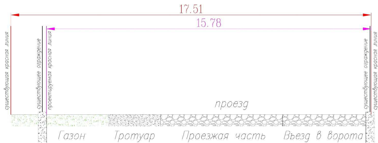
Поперечный профиль проезда от улицы Сиреневая до улицы Радужная (сечение В-В)
