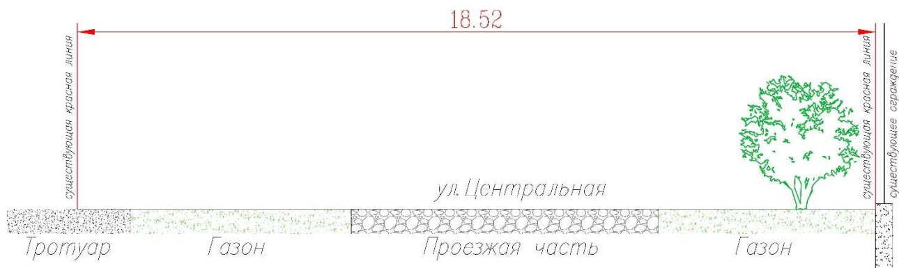
Поперечный профиль улицы Центральная (сечение А-А)
